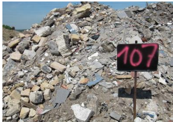
Gemische aus Beton, Ziegel und Keramik, 17 01 07
